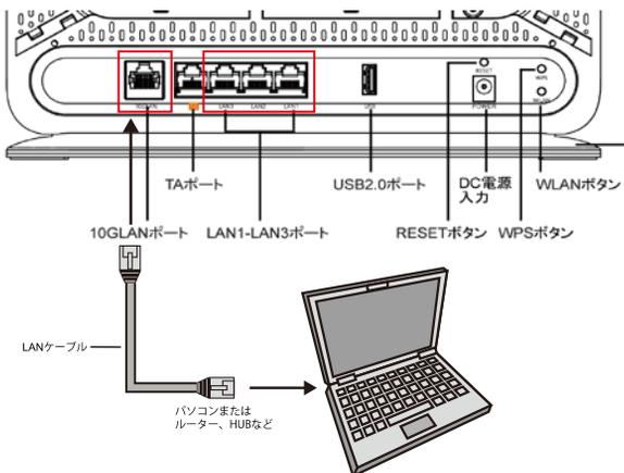
パソコン等の有線デバイスを接続する場合は、背面の**10GLAN**、**LAN1~3**ポートに接続してください。
